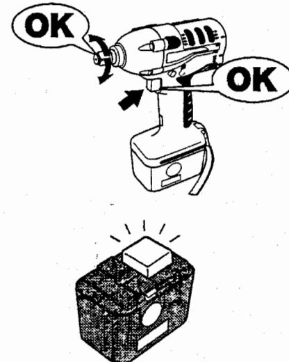
③電池パックを単品で保管するときには付属のパックカバーを端子部にかぶせて短絡を防止してください。
