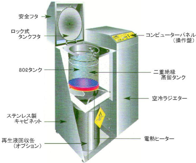
二重絶縁蒸留タンク内に溜まった廃液は電熱ヒーター（単相 200V）で加熱されコンピュータ表示パネルに加熱中であることが表示されます。廃溶剤の場合、加熱後約 30～60 分でタンク内の廃液が沸騰し始め、蒸気がタンク内の蒸留ガス取入れ口よりラジエターパイプの中に入ります。自動空冷強制ファンによりパイプ内のガスが冷却され、瞬時に液体となり回収缶にきれいな常温のシンナー、洗浄剤等が溜まり始めます。この作業が繰り返される事により再生が完了します。また、すべての機種に自動運転・自動停止機能が装備されています。これはマイコン制御により、蒸留タンク及びコンデンサーパイプの温度コントロールが自動的に行われ、空冷強制ファンの停止で安全性が確認された後、運転が自動停止いたします。
