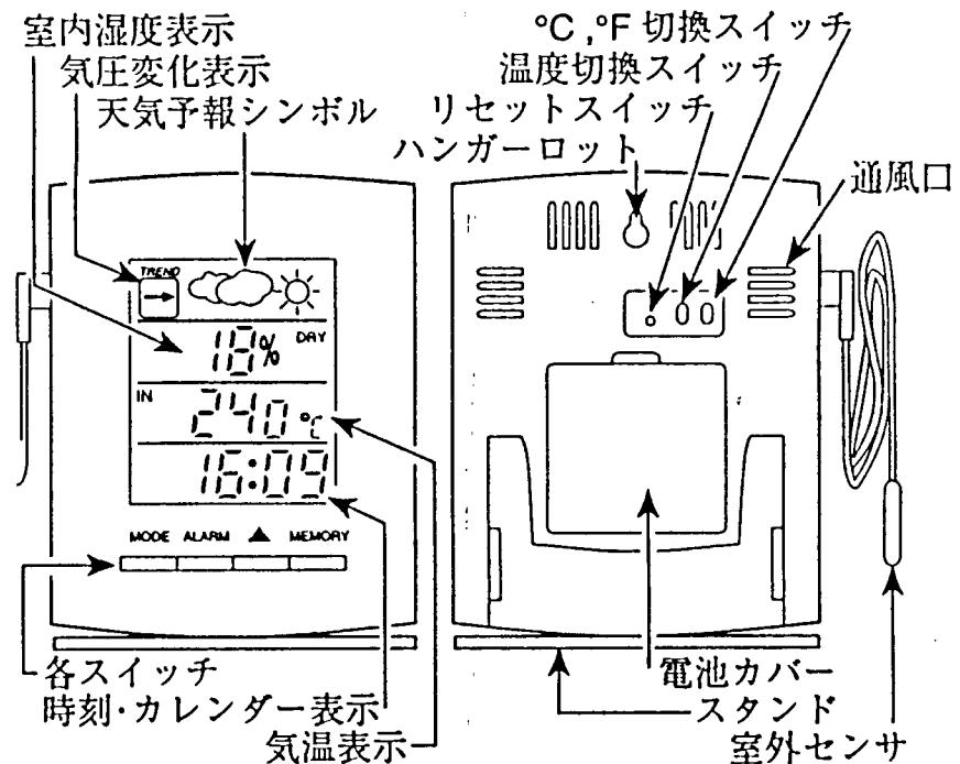
電源が入り最初に出てきた表示のほかに付加機能の表示があります。温度表示は室内または室外温度が選べます。時刻表示は現在の時刻、アラームとカレンダを表示します。付加機能を使うには、「MODE」「ALARM」「MEMORY」のいずれかのスイッチを押してください。
