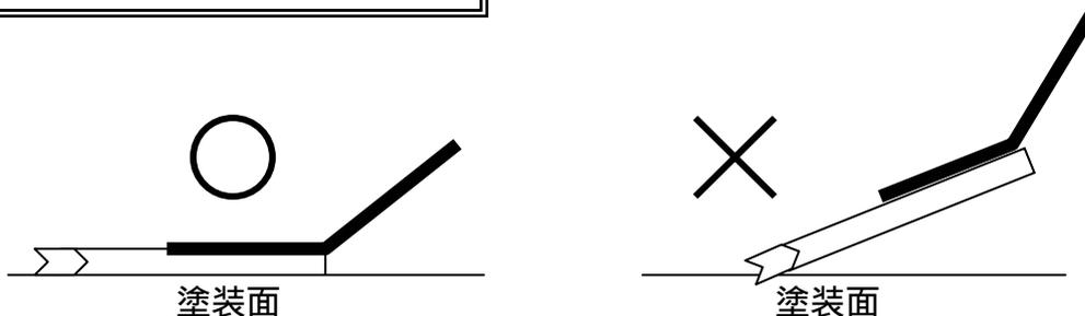
塗装面に対して、水平に当てるようにし指先で押さえるようにしてV型カッターの中心部にてブツ・ゴミ等の頭をカットします。
