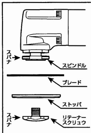
② スピンドルの六角凸部にブレードの12角穴を使う角度に合わせて、きれいにはめ込んで下さい。
