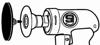
パッドのネジ穴に合わせて、ディスクを差し込みしっかりとロックして下さい。
