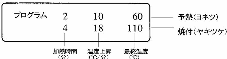
予熱では、ランプをフラッシングさせながら照射物を1分間に10°Cずつ温度を上昇させて2分間で60°Cにします。
