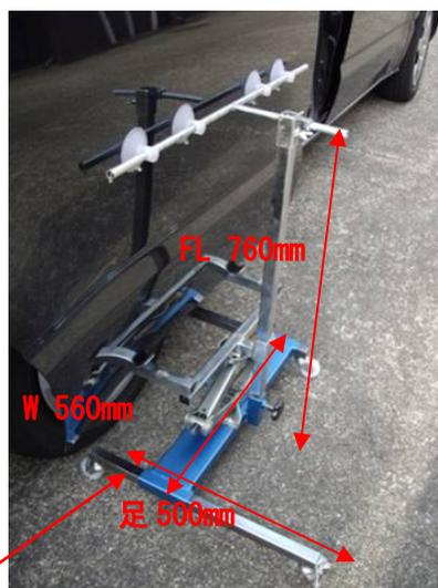
スライドドアの脱着時には簡易型サイドドアリフトの足をスライドさせてタイヤを避けて作業します
