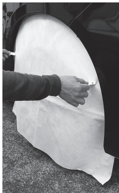
【装着1】 タイヤハウスにTHカバーを差し込みます。
