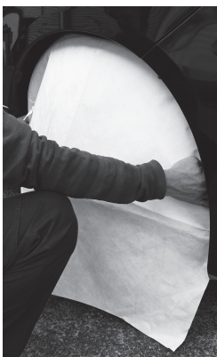
【装着1】 タイヤハウスにTHカバーを差し込みます。
