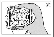
④ 電球ピンと灯具本 体ソケット穴の方向を 確認したのち、電球根 元の溝に、灯具本体ソ ケットアームが入るま で十分に押し込んでく ださい。
