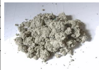
水性塗料の固化状態
