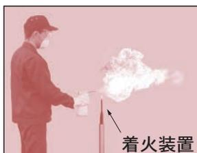
**防錆剤の着火テスト** 危険性確認のテストです。絶対にマネしないでください。液状(原液)では引火しにくい液でも霧状になると引火しやすく写真のように瞬時に着火し非常に危険です。室内で噴霧作業をする場合はよりいっそう火気に注意して十分に換気をおこなってください。
